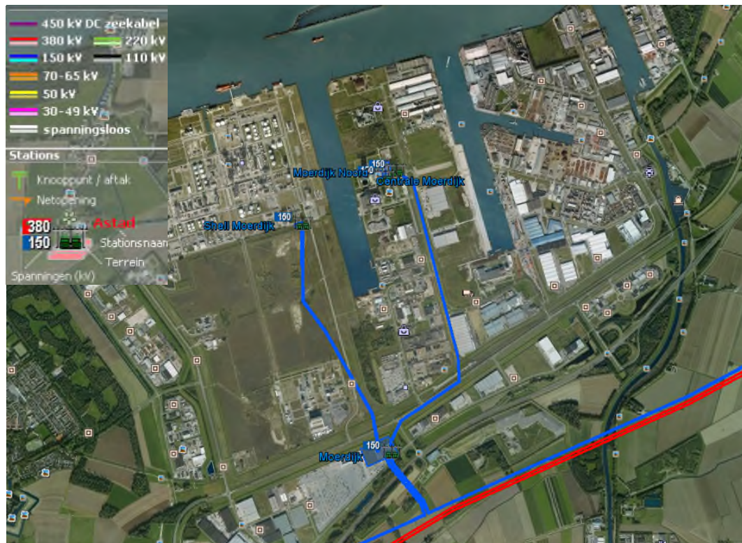
Figuur 8.1: Ligging hoogspanningslijnen (bron: TenneT)
