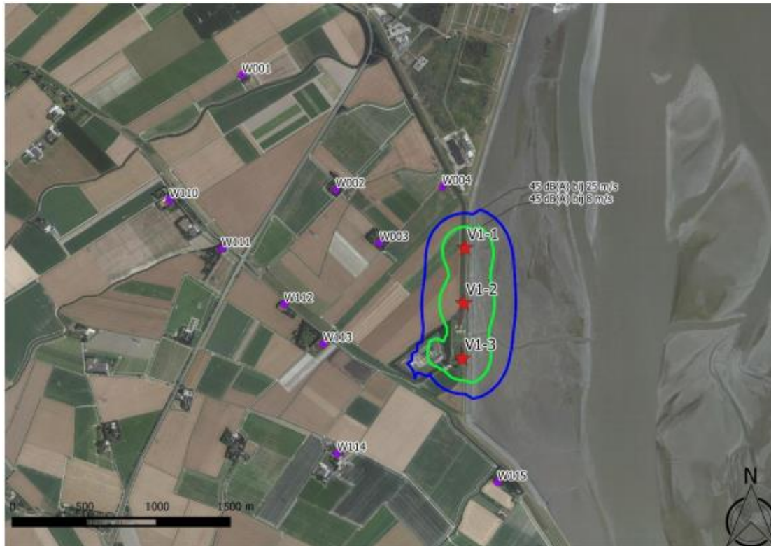
Figuur 27 45 dB(A) LAeq,24h contour bij windsnelheden van 8 m/s (windkracht 5) (groen) en 25 m/s (windkracht 10) (blauw). Ontleend aan: LBP Sight, 2015b
