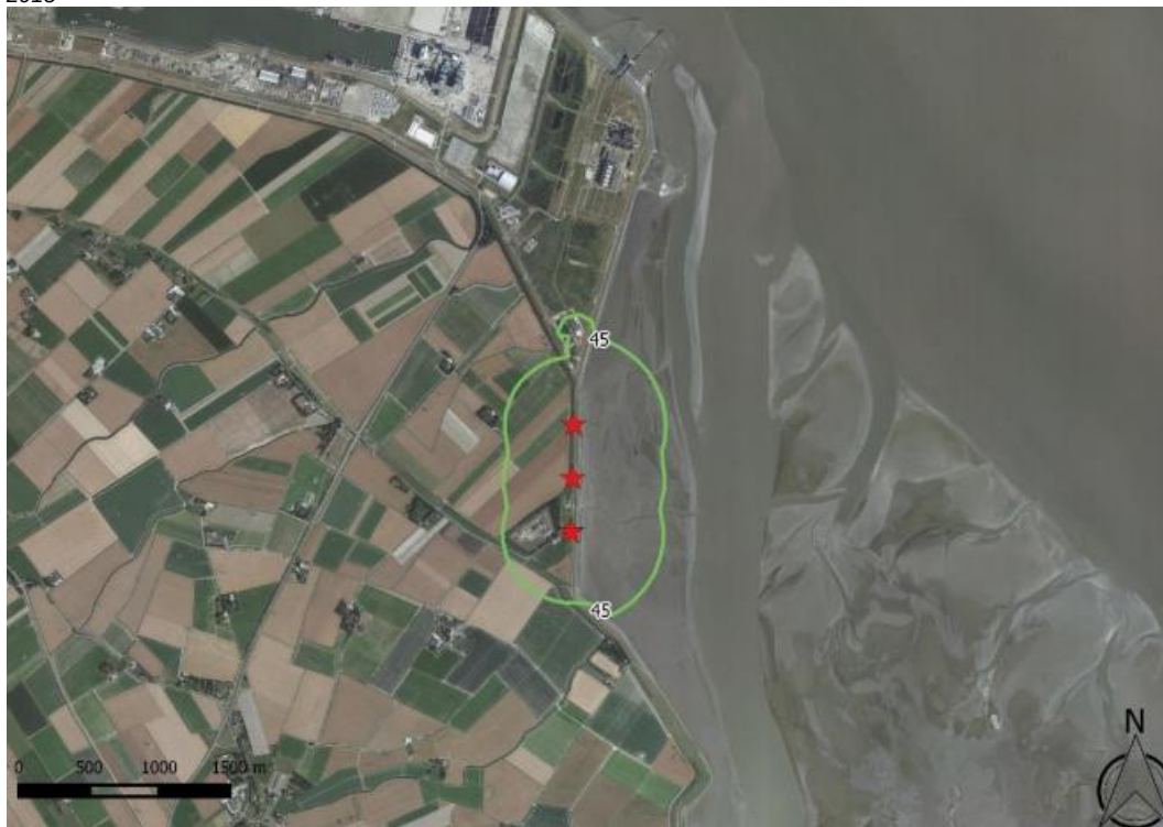
Figuur 22 45 dB(A) contour maximale geluidsniveaus L_{Amax} – Damwanden drukken. Bron: LBP Sight, 2015
