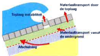
Figuur 7: Instabiliteit steenbekleding (ZST) ten gevolge van meerdere deelmechanismen.
