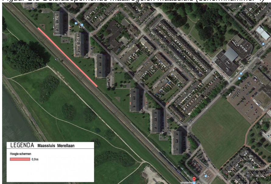
Figuur S.8 Geluidbeperkende maatregelen Maassluis (schermnummer 4)
