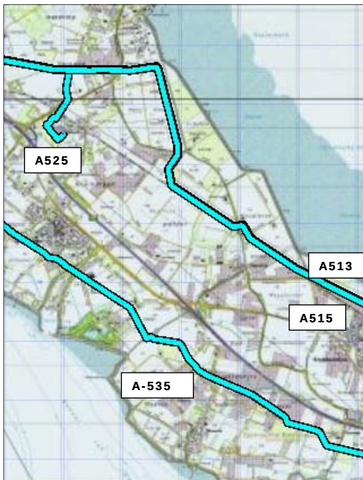
Figuur 3.3. Buisleidingen in interessegebied Olzendepolder, Koringaweg en Nishoek
