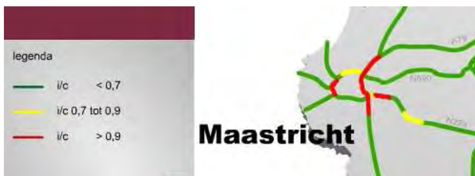
Figuur 4.5: I/C verhouding 2005, nationaal en regionaal verbindend wegennet (bron: mobiliteitsmonitor provincie Limburg)
