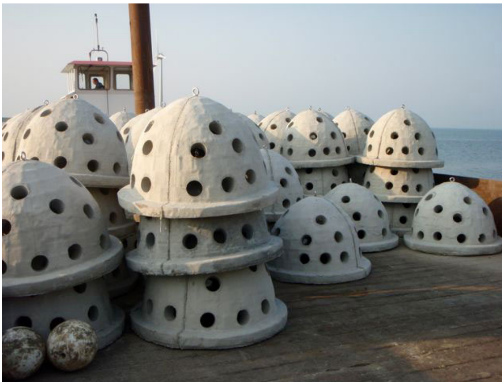
Figuur 9.2. Betonnen rifballen gebruikt in het experiment Waterproeftuin Natuurlijker Markermeer en IJmeer.
