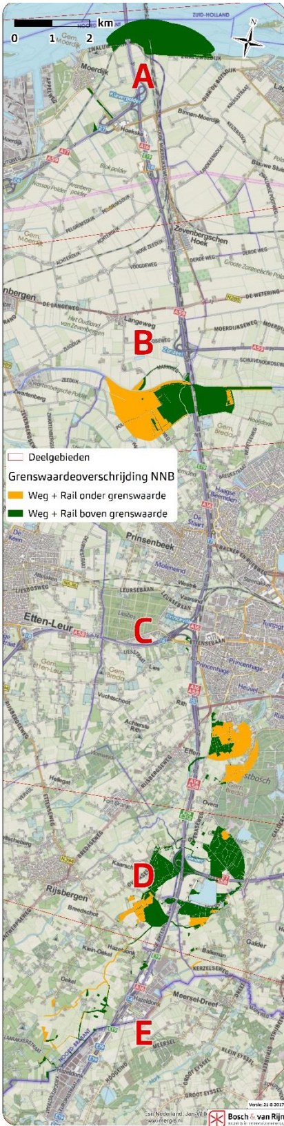
Figuur 7 – Gebied waar het huidige geluidsniveau reeds hoger is dan de grenswaarde uit de ‘rekenregels EHS’ van de provincie.
