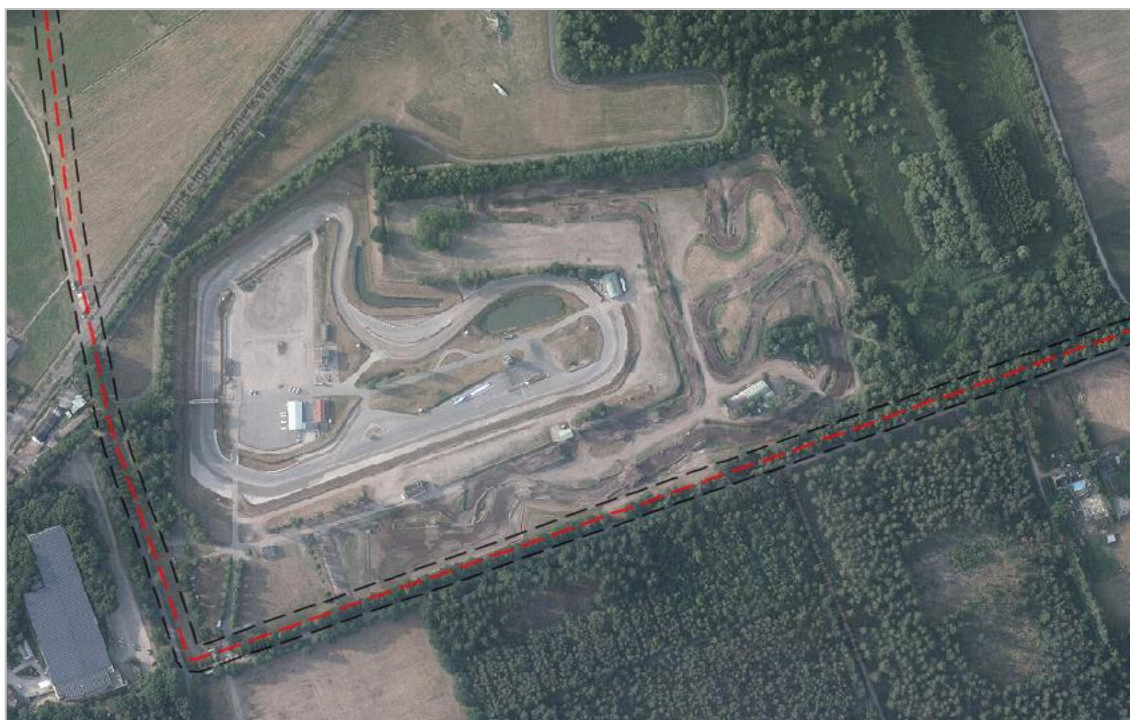
Ligging PRB-leiding met PR 10^{-6} contour, de rode lijn geeft de ligging van de PRB-leiding weer en de zwarte lijn de PR-contour (bron: risicokaart)
