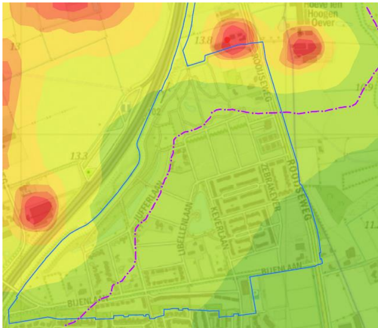
Figuur 3.2. De geurcontour van 10 OU e /m 3 (odour units) geprojecteerd op het Sonniuspark. Dit is de geurcontour voor de huidige situatie (vergunningenbestand veehouderijen van december 2016). Het betreft de contour zonder de mogelijke invloed van de A50 en de geluidswal. Deze is door de ODZOB berekend en ingetekend.
