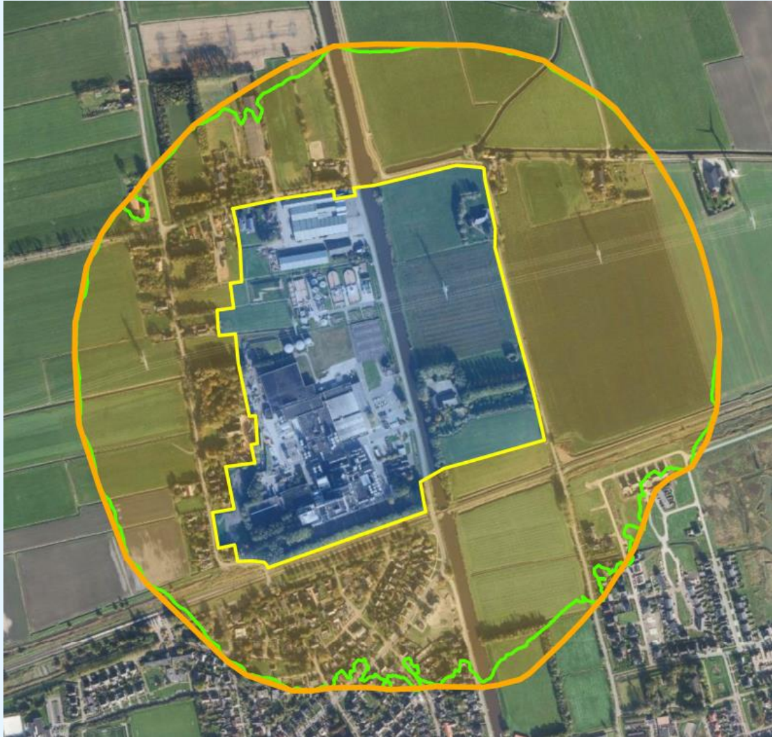
figuur 14: Industrierrein “Bedrijventerrein Noord” Variant zonder omlegging Boterdiep met voorstel gewijzigde zone (oranje), berekende 50 dB(A) etmaalwaarde geluidscontour (groen) en gewijzigde grens van het industrierrein (geel)
