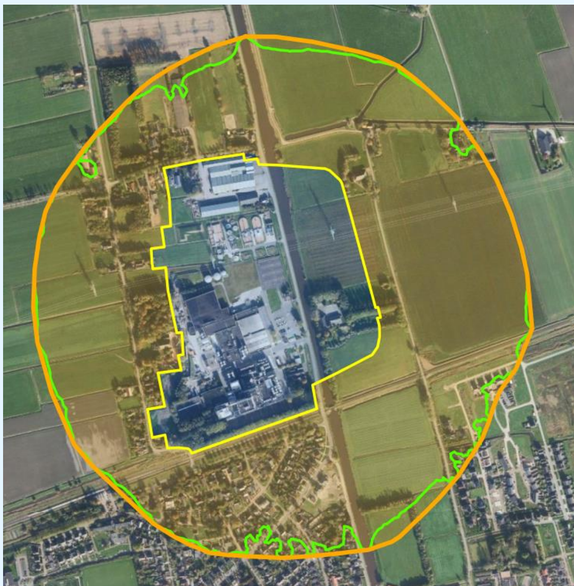
figuur 13: Industrieterrein "Bedrijventerrein Noord" met voorstel gewijzigde zone (oranje), berekende 50 dB(A) etmaalwaarde geluidscontour (groen) en gewijzigde grens van het industrieterrein (geel)
