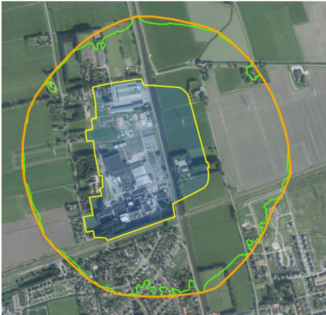
Figuur 5.2 Geluidszone industrieterrein
