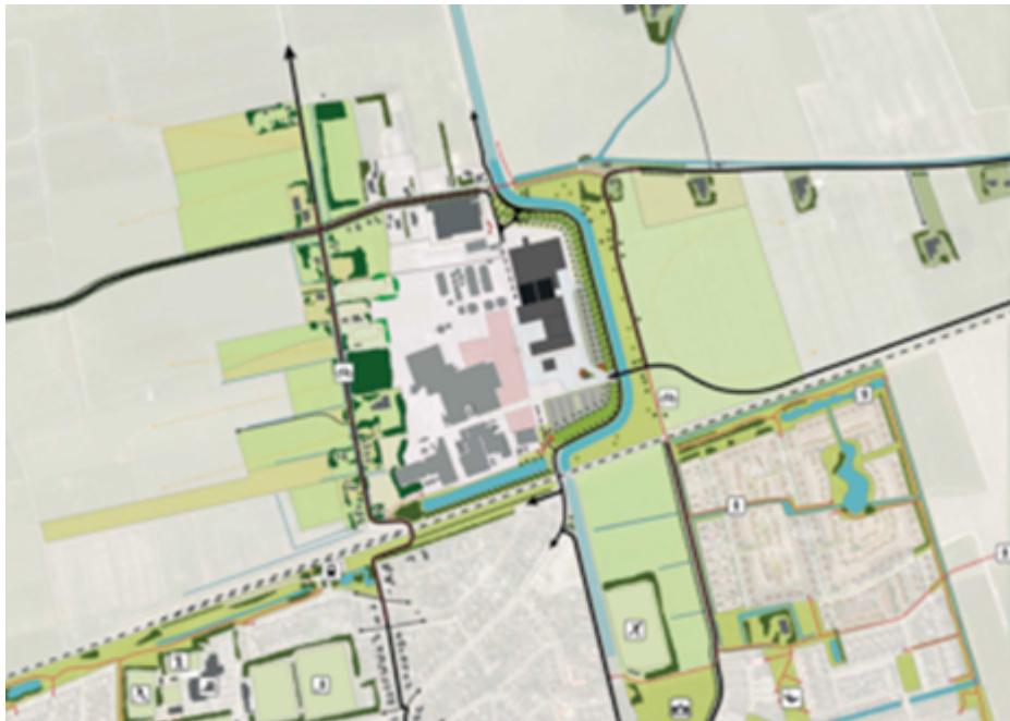
Figuur 2.3: Stedenbouwkundig ontwerp voor de omlegging van het Boterdiep
