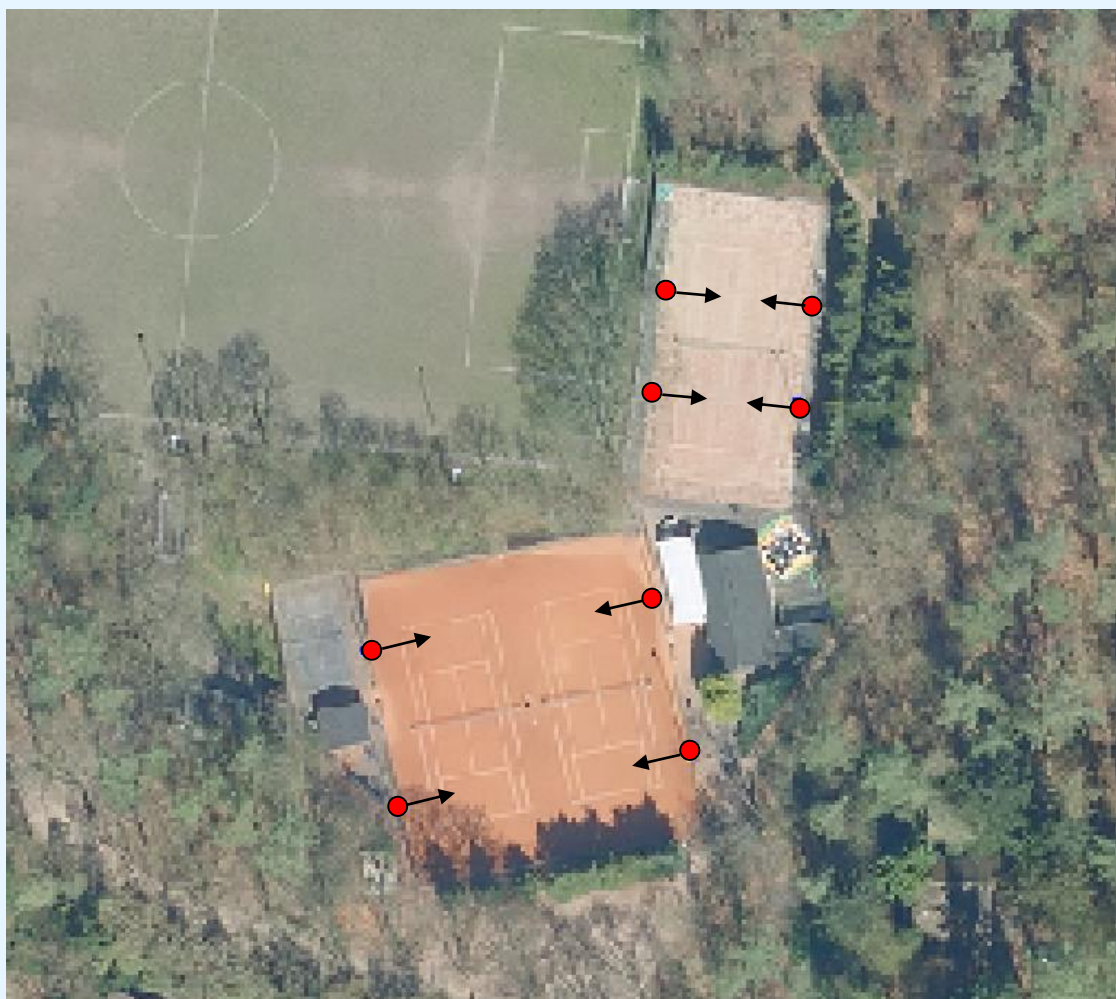
figuur 5: locatie lichtmasten TVO, met de pijlen is de (centrale) uitstralingsrichting van de armaturen aangegeven
