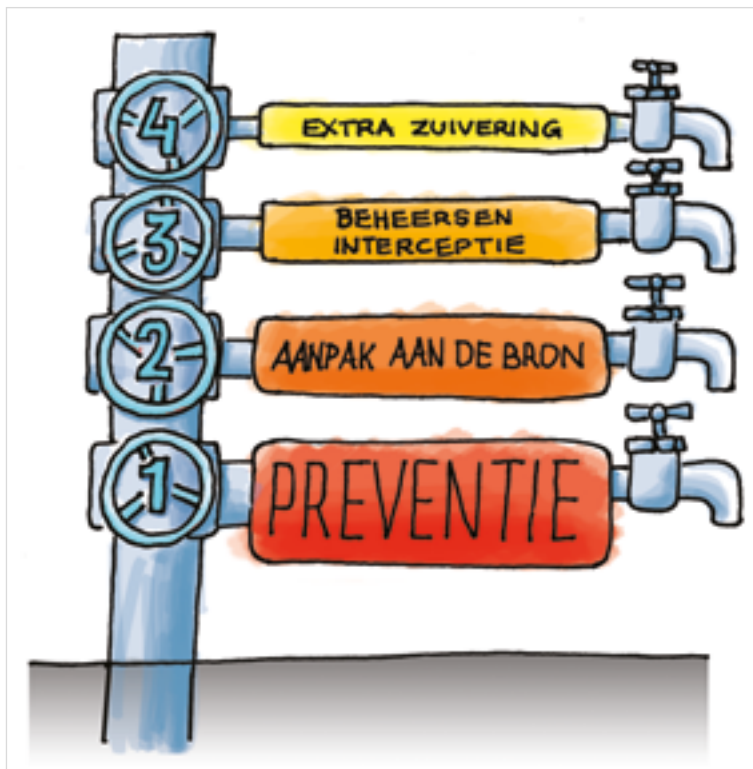
Figuur 4.1: de Preventieladder. Uitgangspunt is preventie (voorkomen dat verontreiniging ontstaat), alleen onder voorwaarden mag worden uitgeweken naar de tweede sport. Hetzelfde geldt voor het uitwijken naar de derde en vierde (minst wenselijke, bovenste) sport. Door: www.gaetano.nl.
