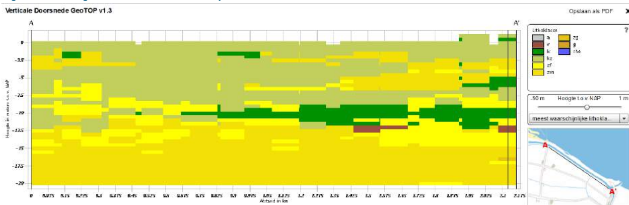
Figuur 4-7 Geologische doorsnede Nieuwe Dijk
