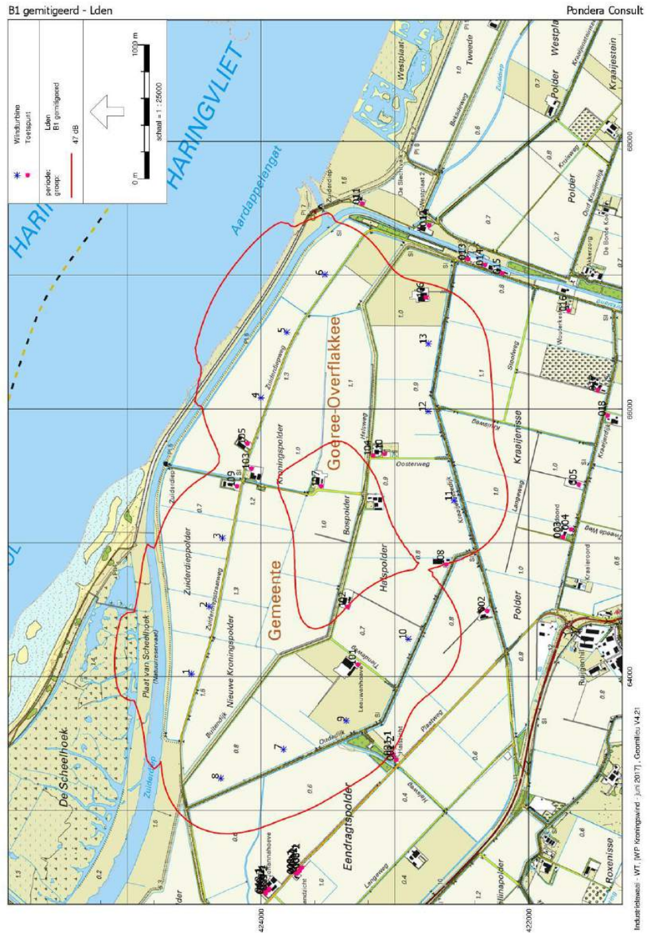
Figuur 5.2 Geluidcontour L den = 47 dB voor alternatief B1 mét mitigatie ter illustratie. Voor de andere alternatieven zijn vergelijkbare kaarten opgenomen in bijlage 3.
