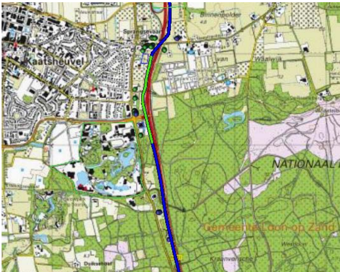
Figuur 4.16. Kilometer leiding behorende bij de maximale overschrijding van de FN-curve voor 5801-LOZ1-10-S 2010-08 (groen)
