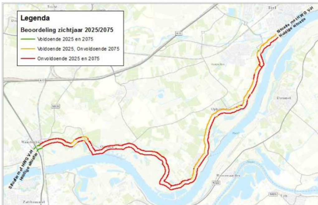
Figuur 6.4 Indicatieve weergave van het hoogtetekort langs de dijk (bron: Waterschap Rivierenland, memo Veiligheidsanalyse, veiligheidsopgave en scopebepaling dijkversterking Tiel-Waardenburg december 2016)
