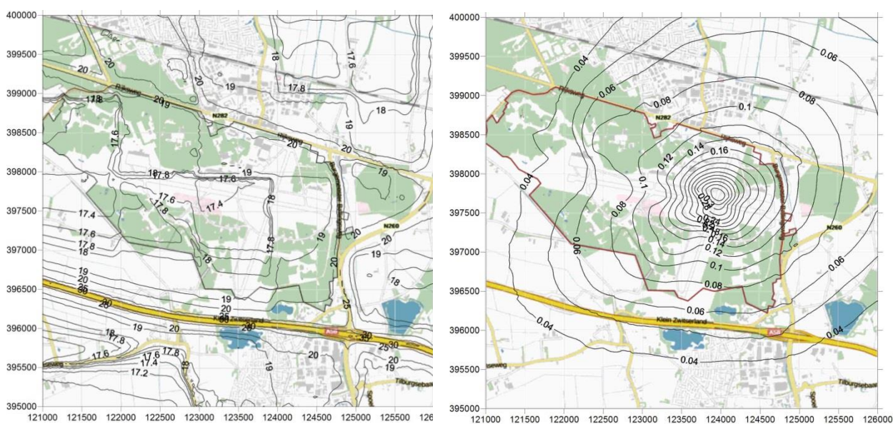
Figuur 5-16: Contourplot van de jaargemiddelde concentratie NO 2 (in \mu\text{g}/\text{m}^3 ) (links) en de bijdrage van de luchtvaart bronnen (warm- en proefdraaien, taxiën en vluchtphase) aan de jaargemiddelde concentratie NO 2 (rechts) voor de referentiesituatie 2016
