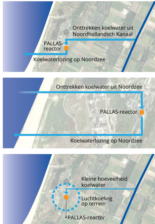
Figuur 9 Drie varianten voor koeling K1 (boven), K2 (midden), K3 (onder)
