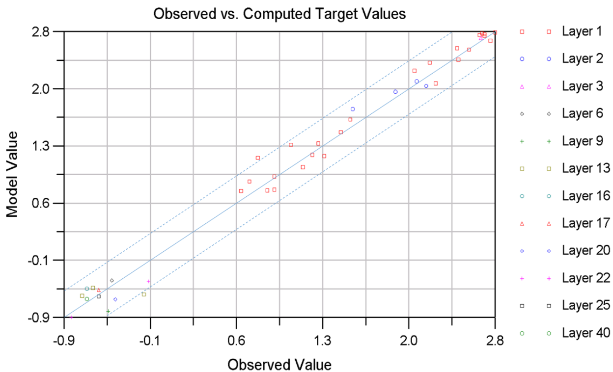
Figuur 22 De gemodelleerde grondwaterstanden uitgezet tegen de gemeten grondwaterstanden
