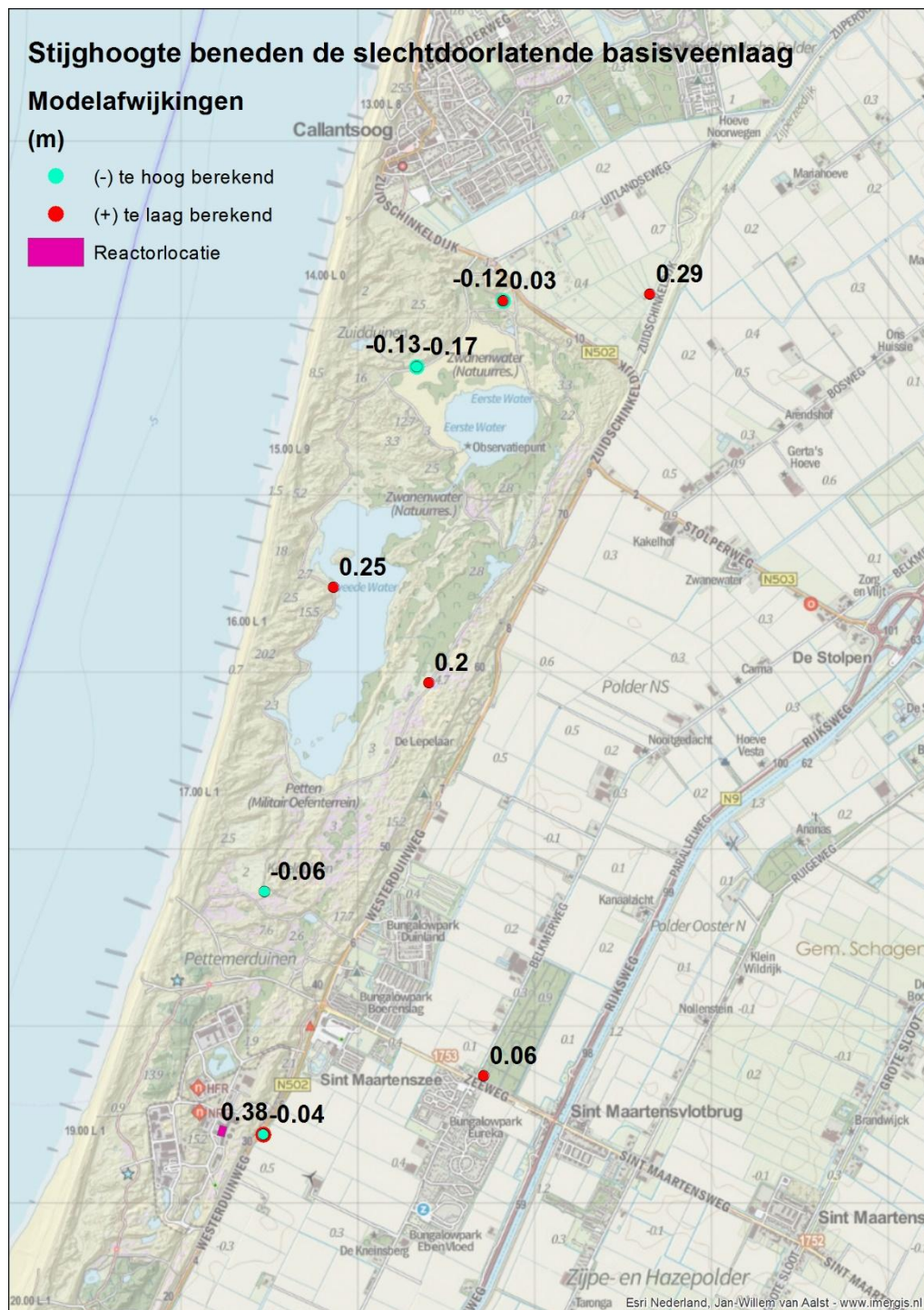
Figuur 21 Modelafwijkingen in het grondwater beneden de slechtdoorlatende basisveenlaag
