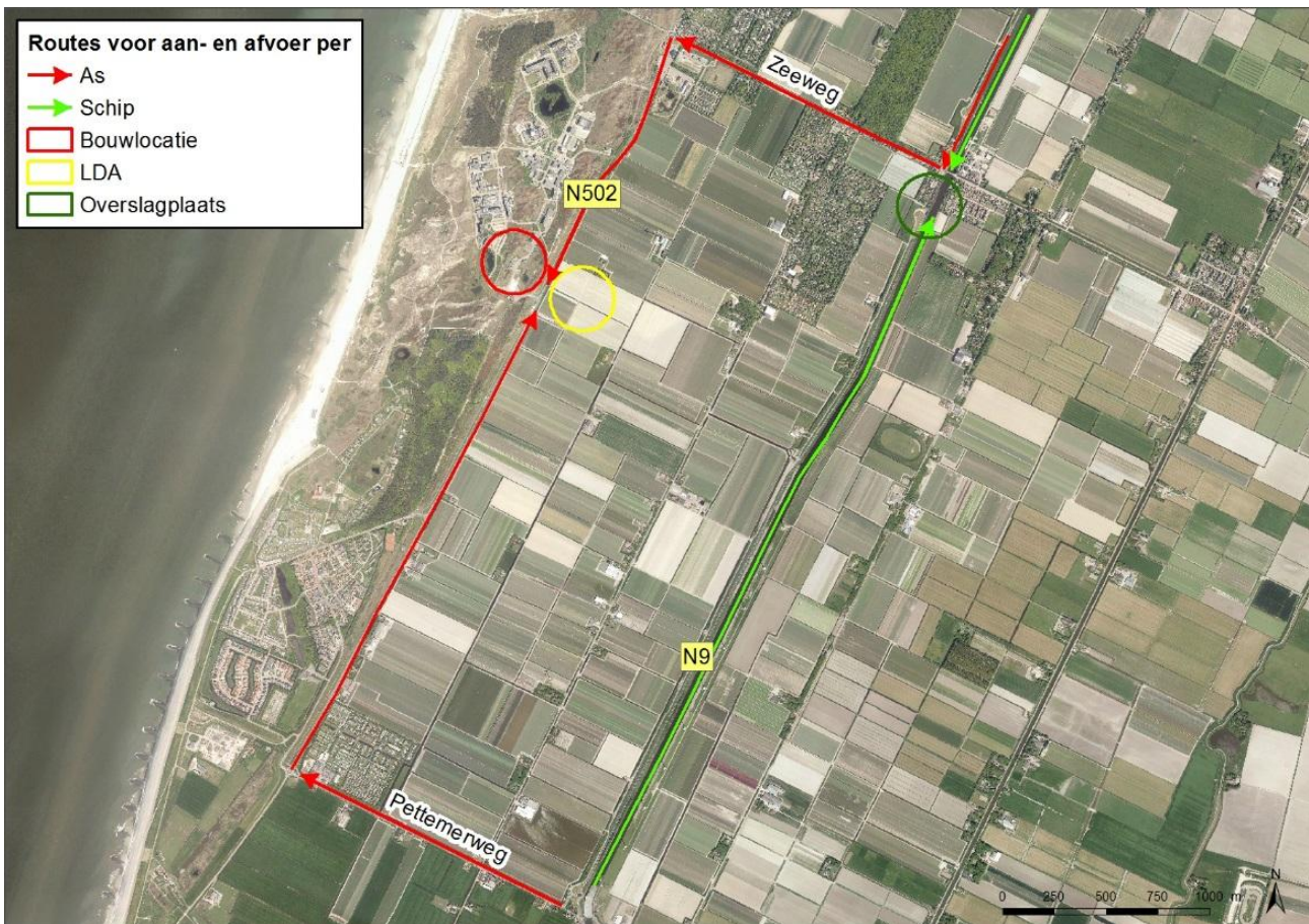
Figuur 8 Onderzochte routes voor aan- en afvoer per as (rood) en schip (groen). De overslagplaats, bouwlocatie en LDA zijn aangegeven met respectievelijk een groene, rode en gele cirkel
