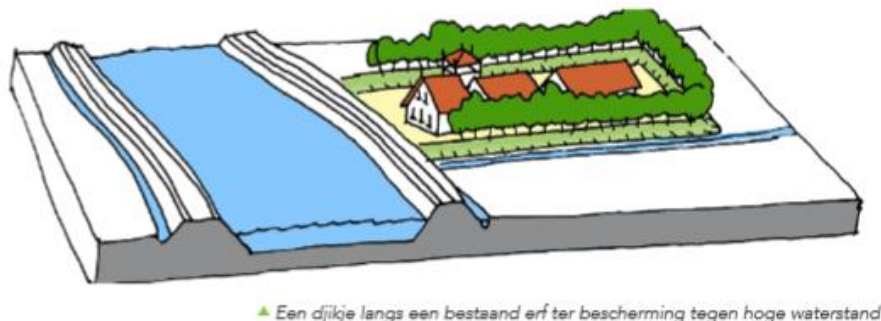
▲ Een dijke langs een bestaand erf ter bescherming tegen hoge waterstand
