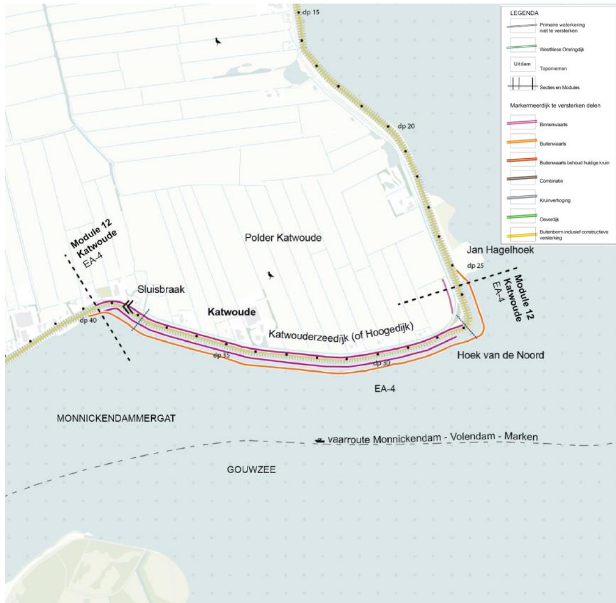
Figuur 15: De versterking in Module 12
