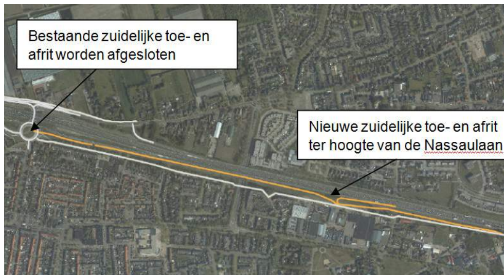
Figuur 3.4 Het principe van de Variant met de verlegde toe- en afrit. Oranje lijnen zijn de nieuwe parallelweg en de verlegde toe- en afrit.
