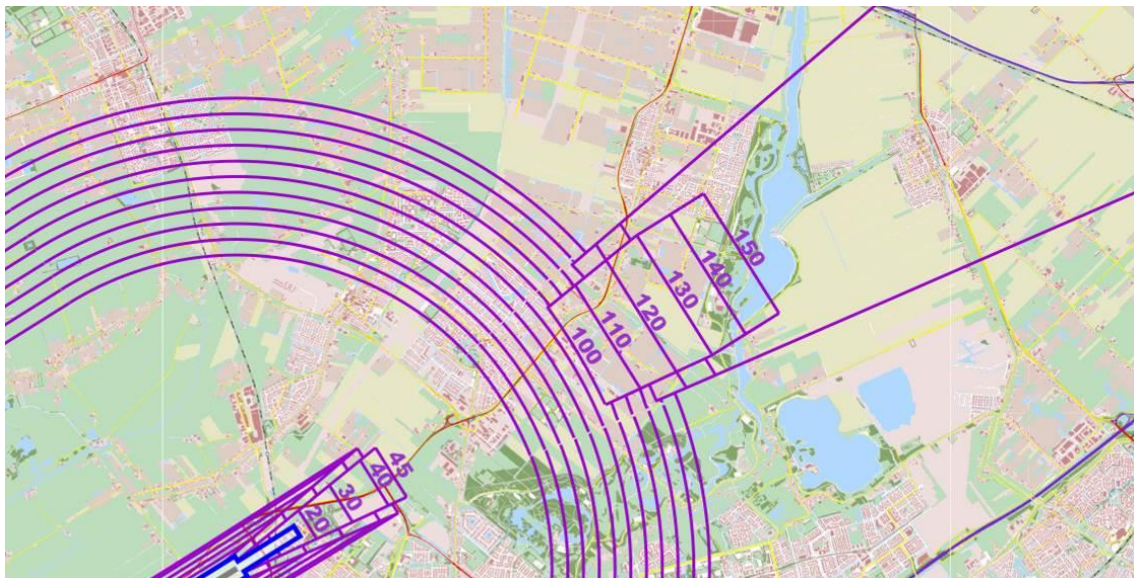
Afbeelding 7.5.: uitsnede kaart hoogtebeperkingen invliegfunnel Rotterdam The Hague Airport. Het plangebied is buiten het kaartbeeld gelegen.
