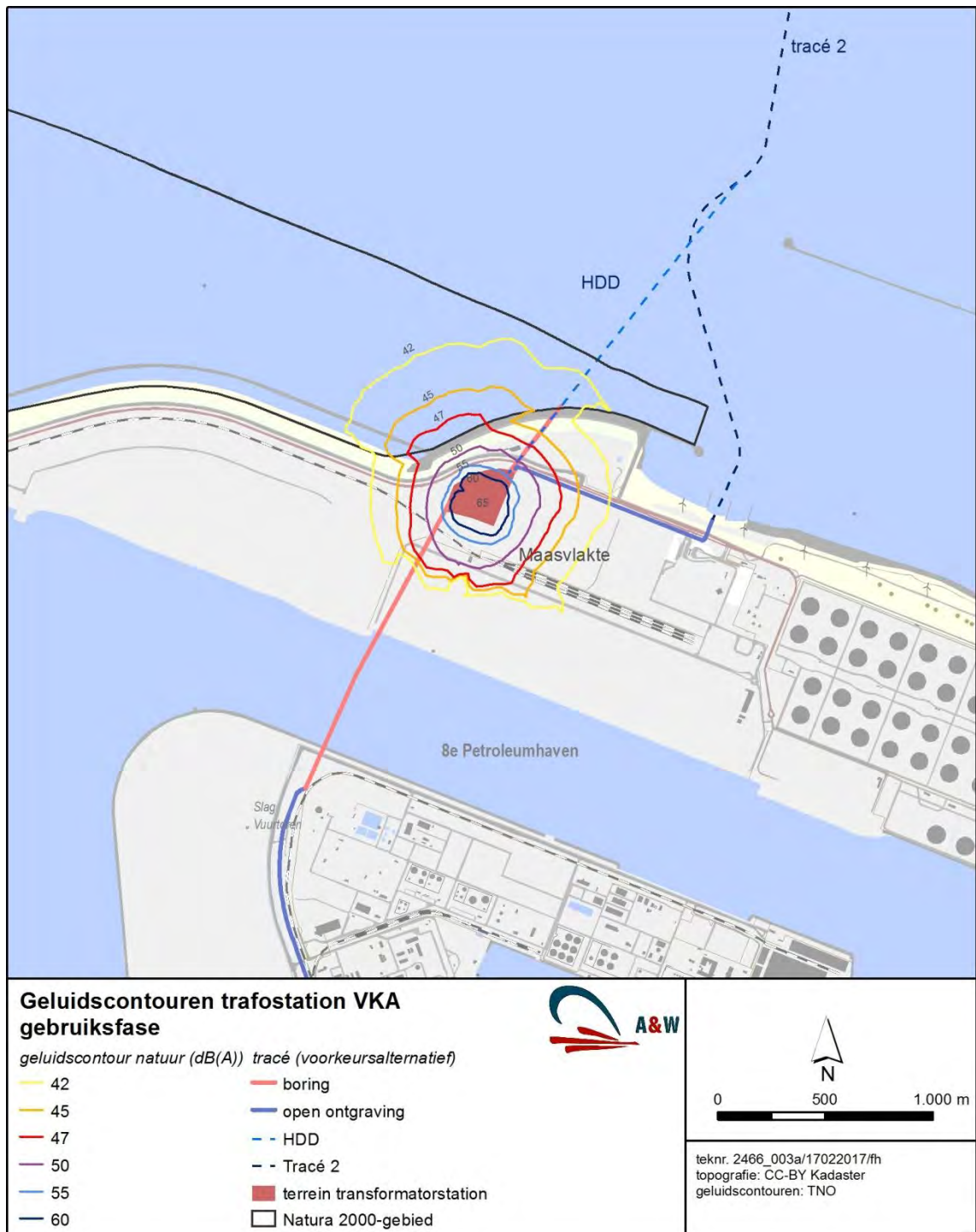
Afbeelding 6.3 Gebruiksfase: Geluidscontouren transformatorstation in de gebruiksfase
