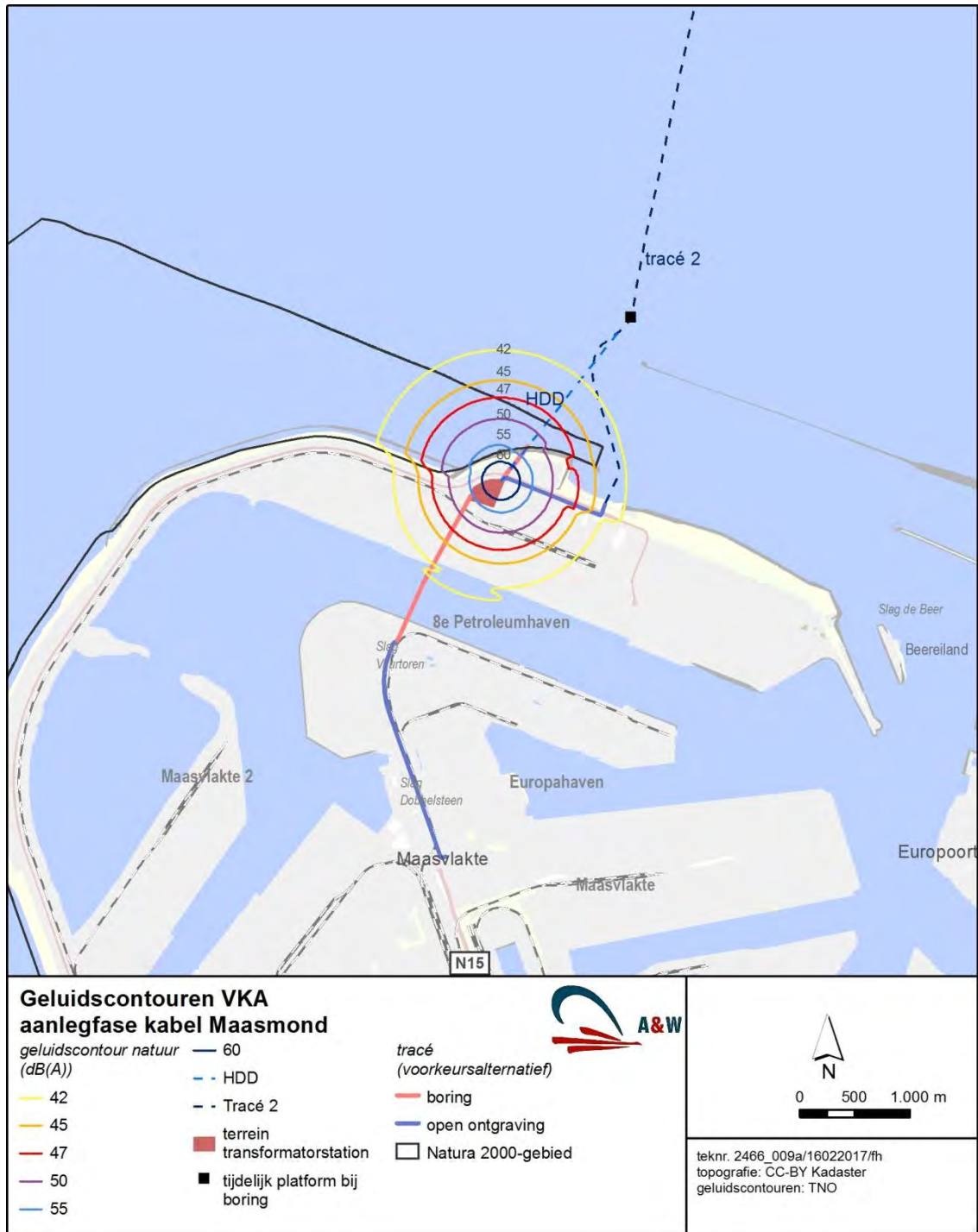
Afbeelding 6.2b Aanlegfase: Geluidscontouren rond HDD boring Maasmond
