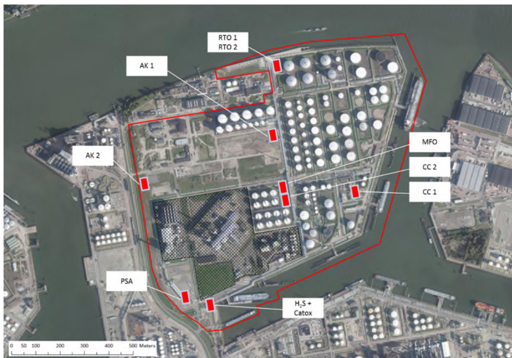
Figuur 4.15: Ligging dampbehandelingsinstallaties
