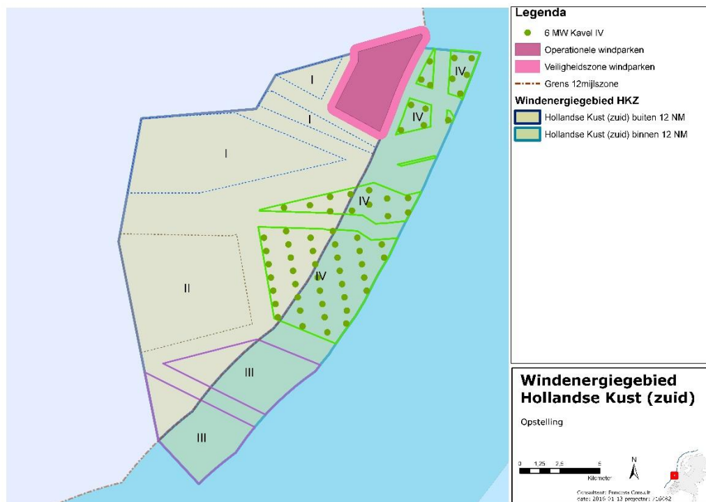
Figuur 2.2 Opstelling met 63 turbines van 6 MW.
