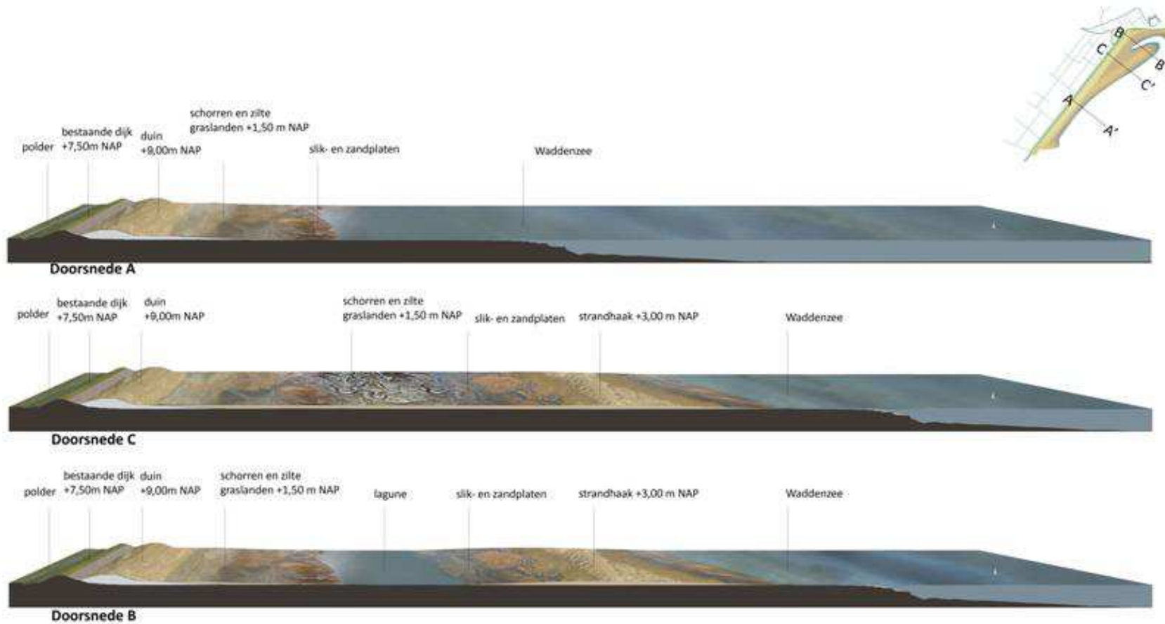
Afbeelding 2.3 Visualisatie Prins Hendrikzanddijk, dwarsdoorsneden
