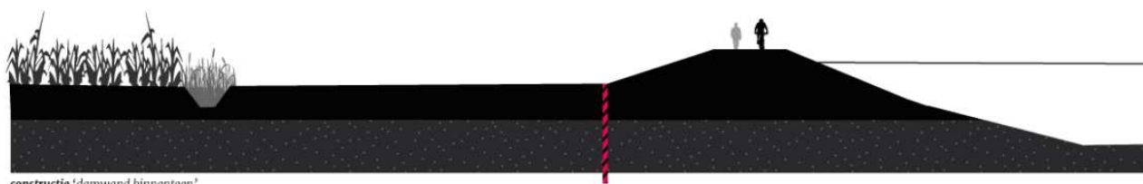
constructie 'damwand binnenteen'
