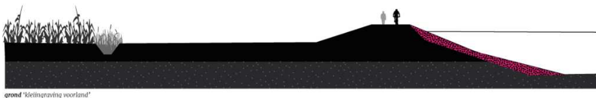
Figuur 4.1 Aanleg pipingberm en kleiingraving voorland.
