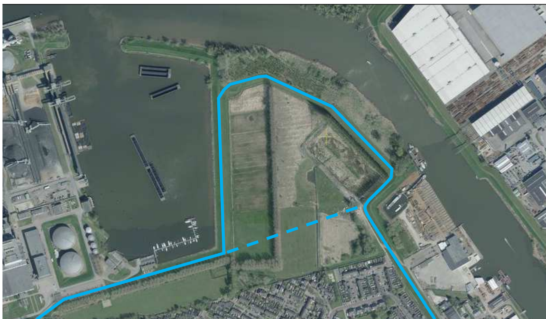
Figuur 4.14 Dijkverlegging Slikpolder (onderbroken lijn).
