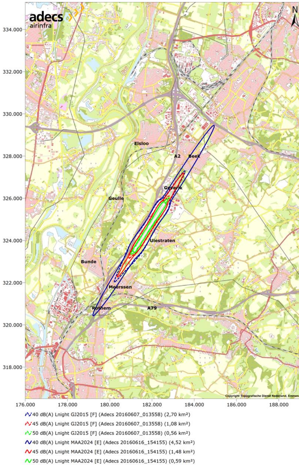
Figuur 4-11 Vergelijking L_{night} -contouren huidige situatie (stippellijn) en LHB-situatie MAA-2024 (volle lijn) (bron: fig. 40 van bijlage 2)
