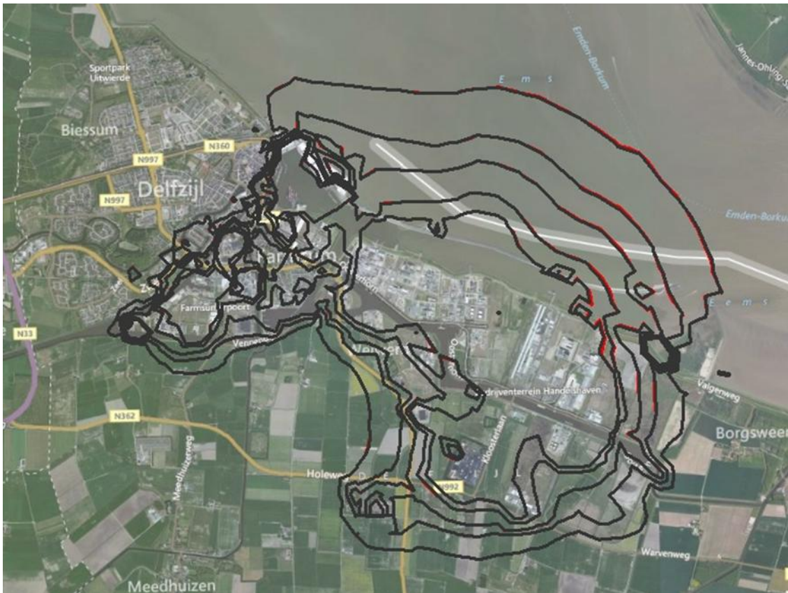
Afbeelding 11: Vergelijking tussen de geluidcontouren in Oosterhorn in de huidige situatie (zwarte contour) en de geluidscontouren in de gebruiksfase inclusief de derde productielijn van EEW (rode contour).
