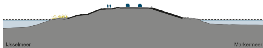
Figuur 14 Dijkvak 6: schematisch dwarsprofiel huidige situatie
