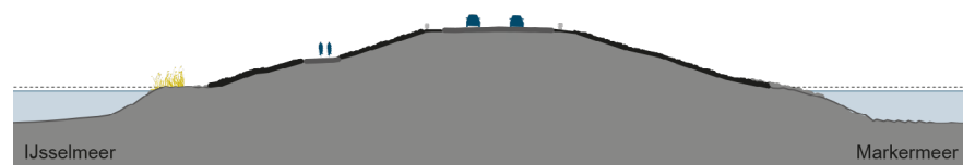
Figuur 10 Dijkvak 4: schematisch dwarsprofiel huidige situatie
