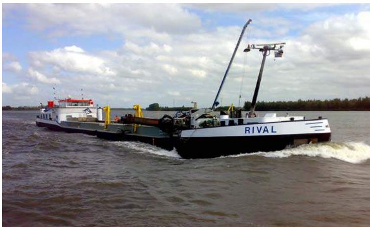
Figuur 2.5. Sleephopperzuiger Rival van Van Oord Nederland (voorbeeld van materieel dat ingezet kan worden).
