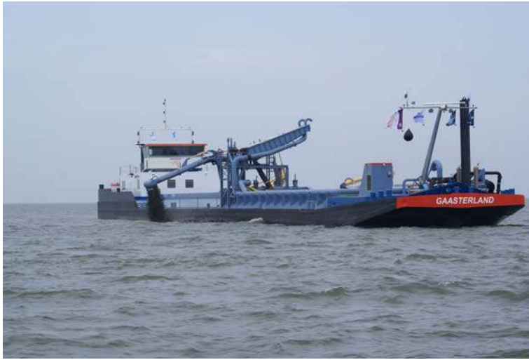
Figuur 2.4. Diepzuiger Gaasterland van Mineralis (voorbeeld van materieel dat ingezet kan worden).
