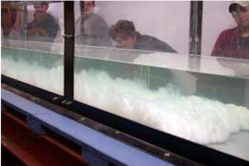
Figuur 5 Dichtheidsstroming in een laboratoriumopstelling, de bodem van de waterbank is nagenoeg horizontaal
