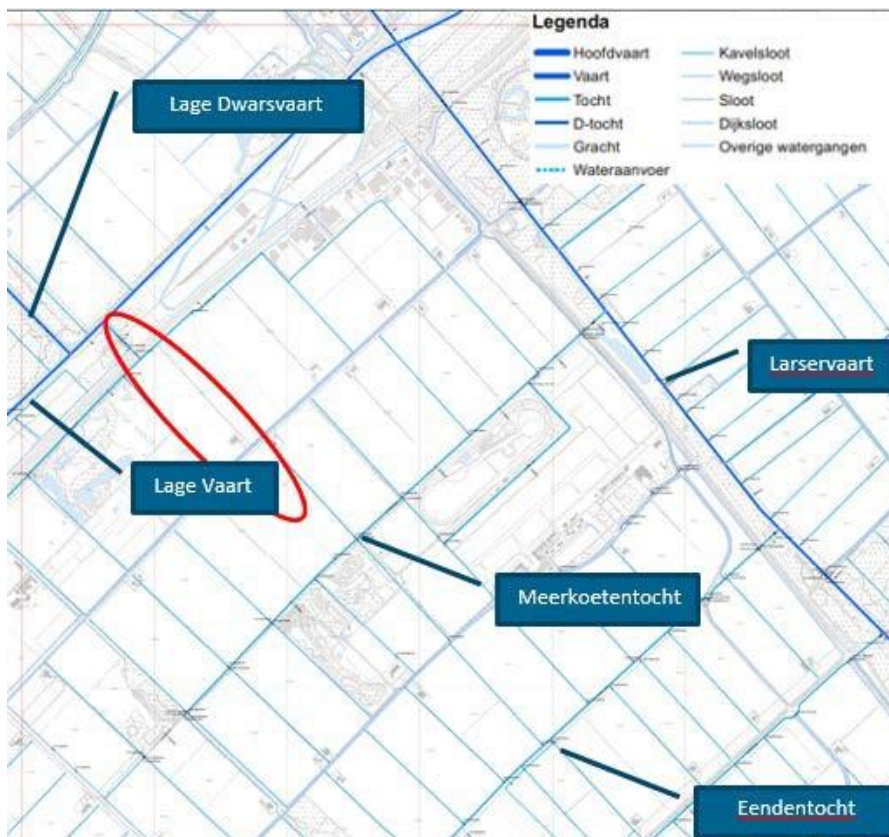
Figuur 6.7: Overzicht bestaande waterstructuur plangebied [legger Zuiderzeeland]
