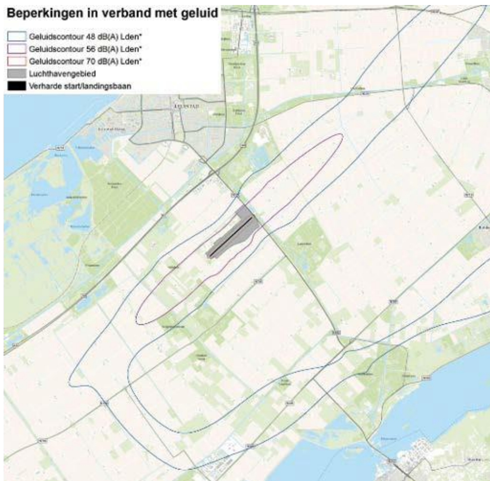
Figuur 3.1: Beperkingen in verband met geluid (Luchthavenbesluit). Binnen de 56 dB-contour is het toevoegen van geluidgevoelige objecten niet mogelijk.
