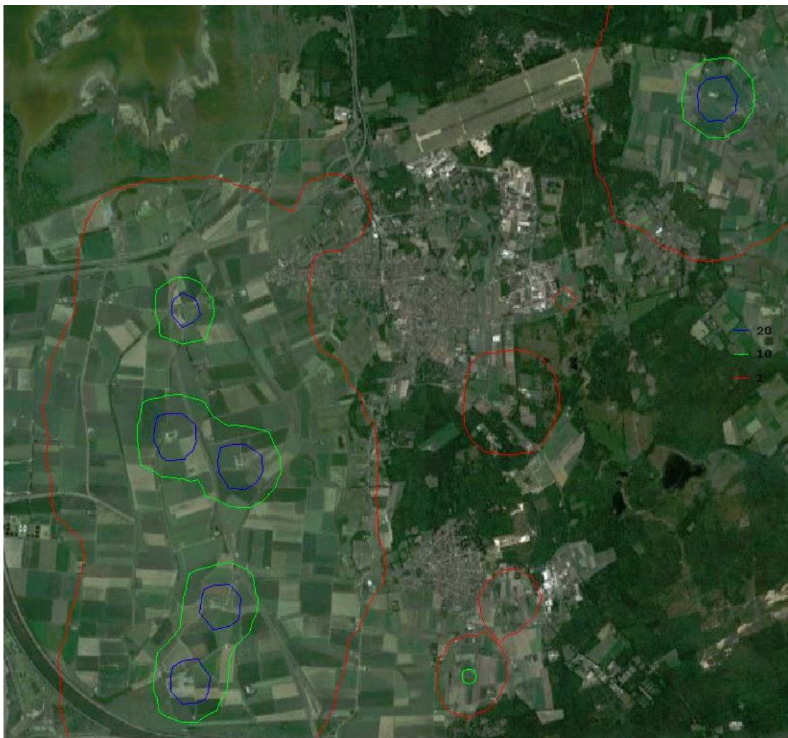
Figuur 6.2 Geurbelasting maximale invulling (blauw = 20 ouE/m 3 , groen = 10 ouE/m 3 , rood = 1 ouE/m 3 )
