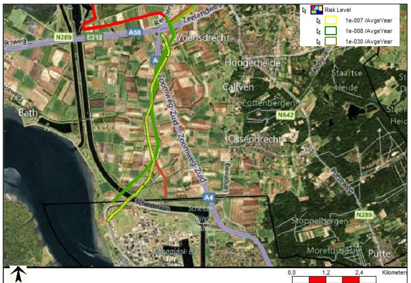
Figuur 12: Traject 3, plaatsgebonden risico koolmonoxideleiding
