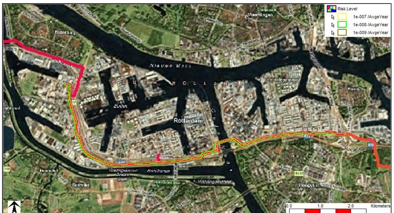
Figuur 22: Traject 4, plaatsgebonden risico koolmonoxideleiding
