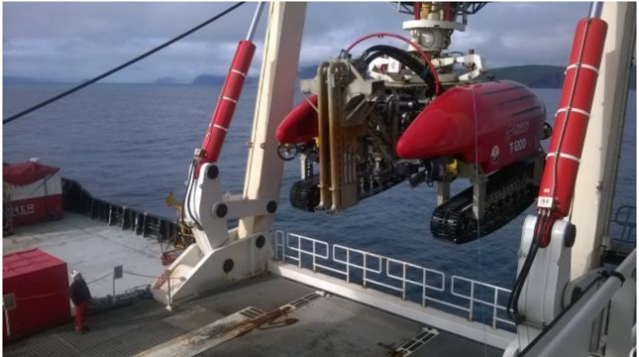
Figuur 6 Een typische ROV jettrencher: de T1200 van Canyon
