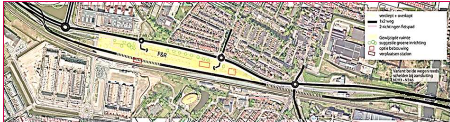
Figuur 4.2: Schematische weergave alternatief 2; doorgaand verkeer wordt gescheiden van lokaal verkeer
