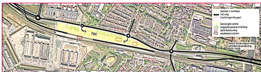
Figuur 12.1: Schematische weergave alternatief 2, doorgaand verkeer wordt gescheiden van lokaal verkeer
