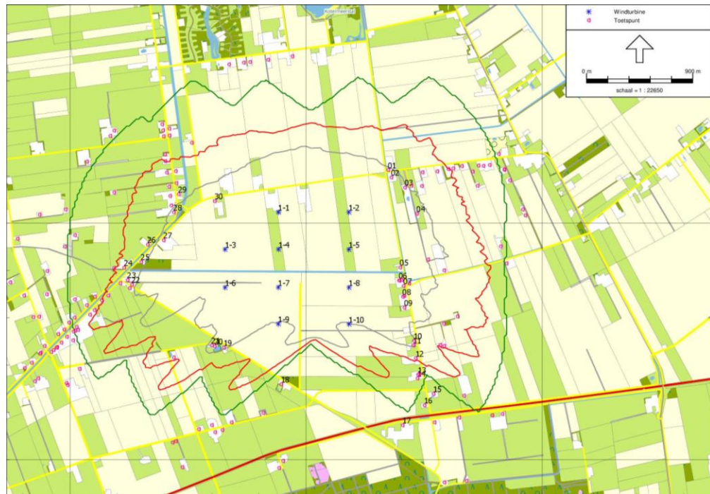
Figuur 5.3 Jaarlijkse slagschaduwduurcontouren op ashoogte 135 meter (groene, blauwe en rode lijn staan voor respectievelijk 0, 5 of 15 uur slagschaduw per jaar)
