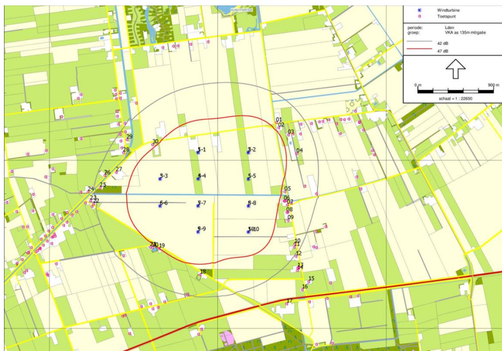
Figuur 5.2 Geluidcontour (worstcase: Vestas V110) L_{den} van Windpark de Veenwieken op 135 meter ashoogte, na mitigatie
