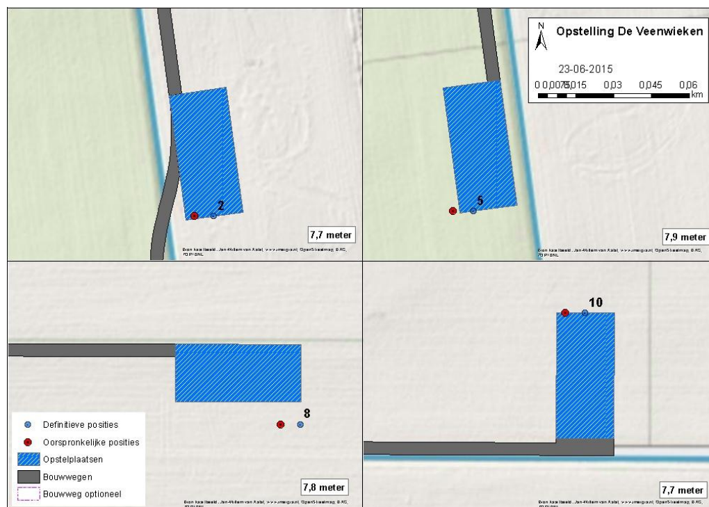
Figuur 5.1 Illustratie aangepaste turbineposities bestemmingsplan/inpassingsplan
