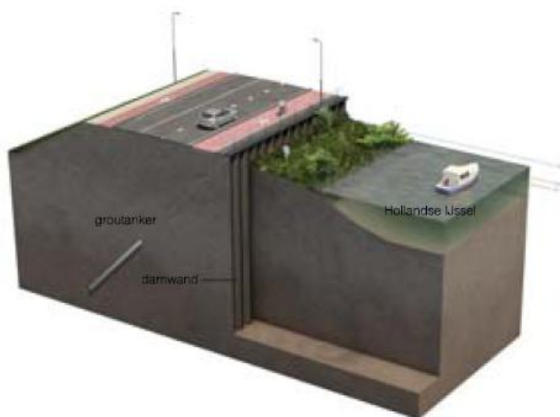
Figuur 4.3.1 Alternatief 2 variant verlaagd talud
