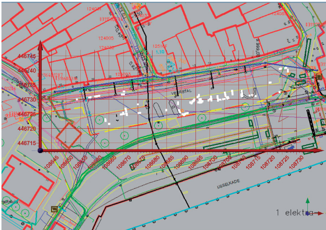
Afbeelding 5.2 Resultaten grondradaronderzoek Veerstal met in witte blokken de 'relevante reflecties'
