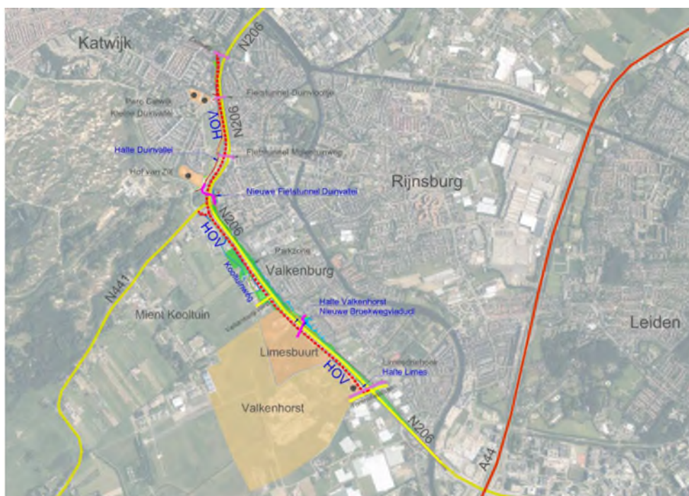
Figuur 1 HOV-busbaan Leiden –Katwijk met de twee beoogde busbaandelen, aangegeven in rode blokjes en bijbehorende voorzieningen (aanleg nieuwe bushaltes en ongelijkvloerse kruisingen met het overige (langzame) verkeer). Busbaan-deel Valkenhorst loopt van Halte Limes tot de Wassenaarseweg (N441). Busbaan-deel Duinvallei loopt van de Wassenaarseweg (N441) tot de Zeeweg in Katwijk (Bron MER).
