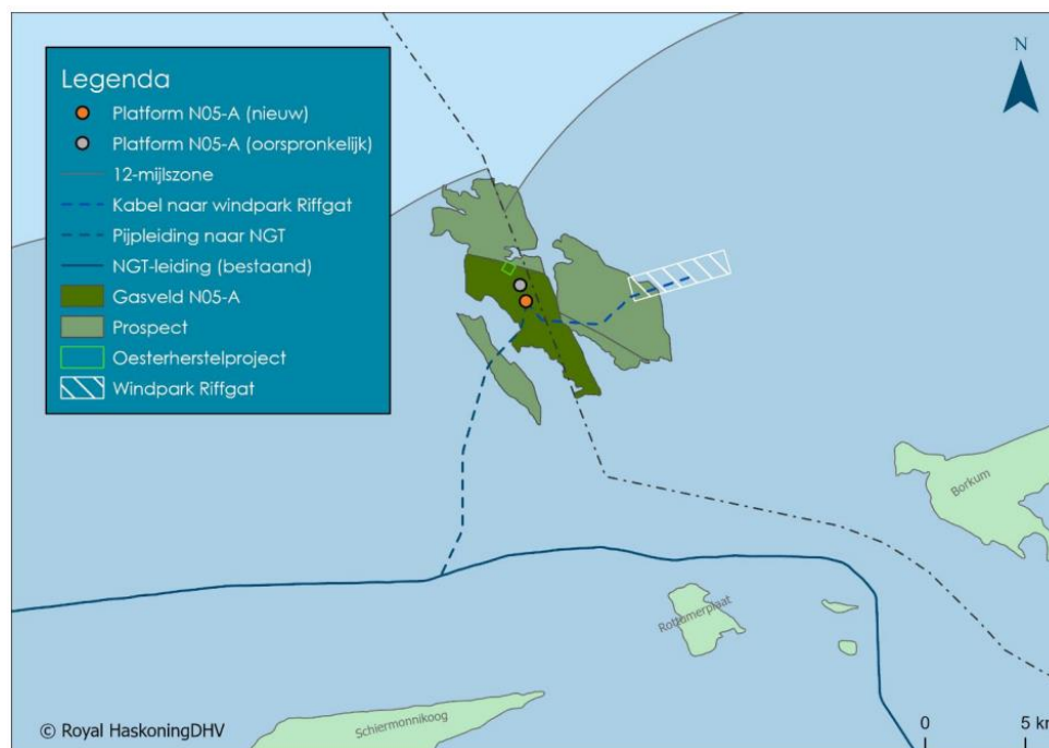
Figuur 1. N05-A aardgasveld, oorspronkelijke en nieuwe locatie van het boor- en productieplatform, inclusief de ligging van de gasvelden en de nieuwe tracés van de gasleiding en de kabel vanuit windpark Riffgat. Bron: Aanvulling MER gaswinning N05-A.
