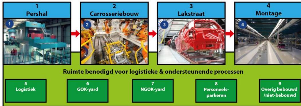
Figuur 2: Schematische weergave van de belangrijkste stappen uit het productieproces van VDL Nedcar. (bron: Concept-NRD 'Uitbreiding VDL Nedcar. Antea Group, 17 juni 2019.)
