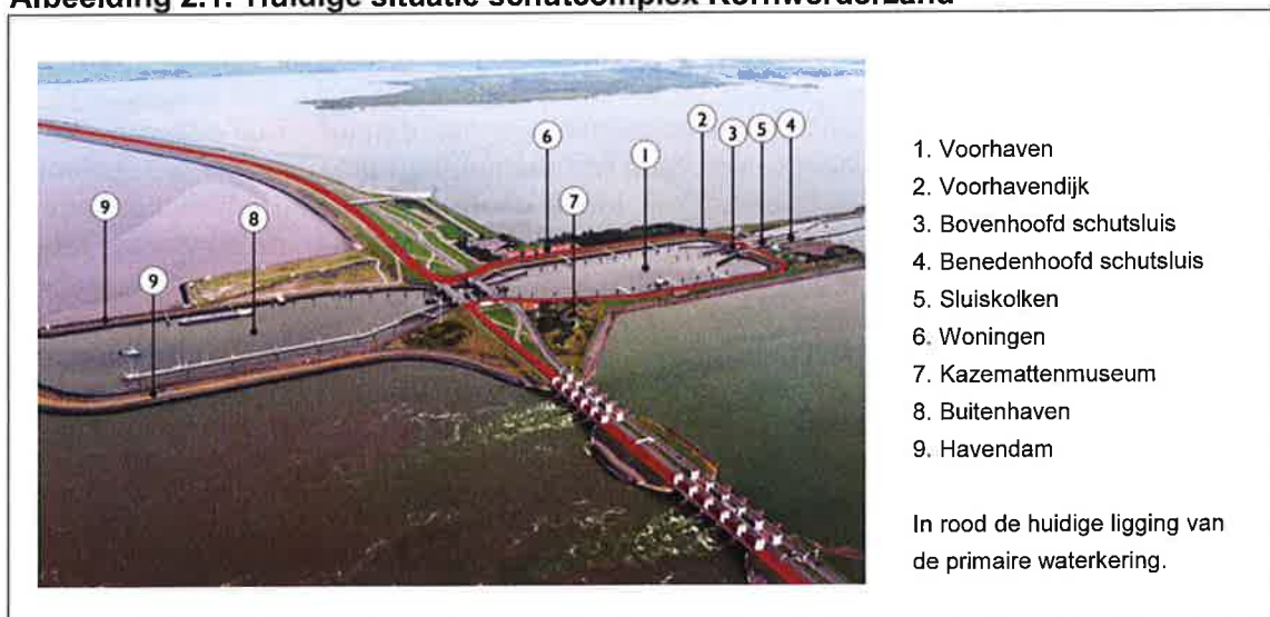
Afbeelding 2.1. Huidige situatie schutcomplex Kornwerderzand
