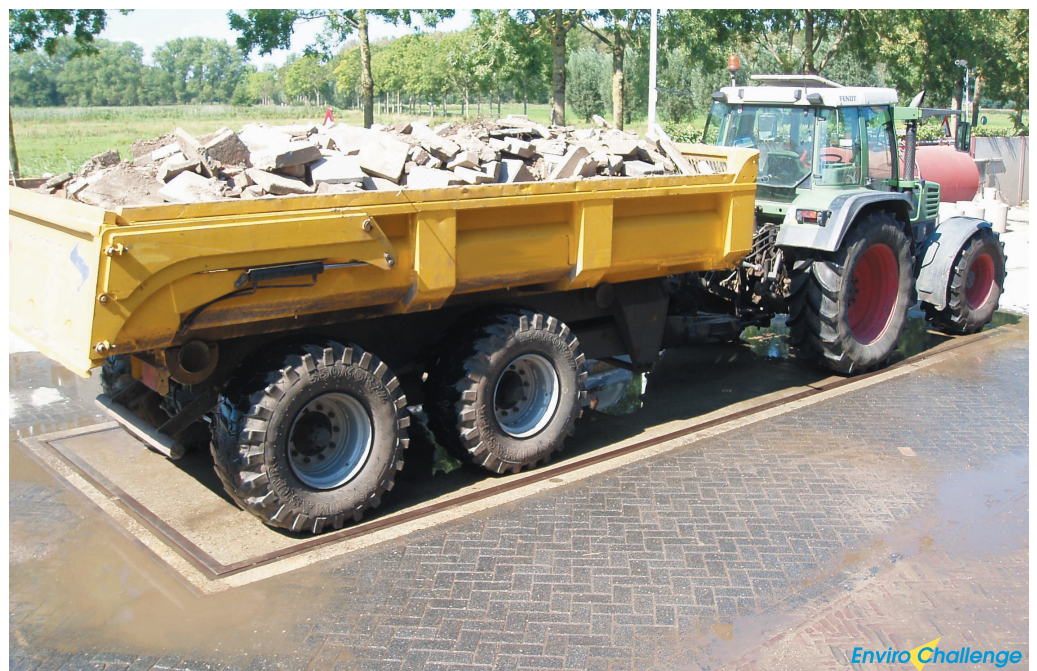
Illustratie 7 : Wegen van vrachten op de weegbrug (stationair draaiende motor) (RBS)
