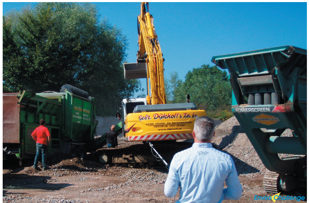
Illustratie 4 : Geluidmeting bij zeven van granulaat en granuleren van puin (RBS)
