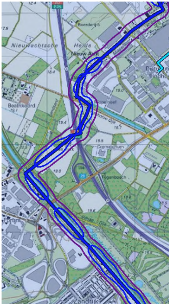
Figuur B2.2: PR 10^{-7} - (blauw) en PR 10^{-8} -contour (paars) van leiding Z-506-01
