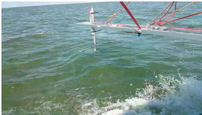
Afbeelding 10b: De gradiometer aan bakboordzijde
