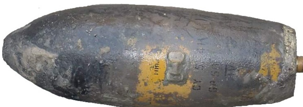
Afbeelding 6: Een 500 lbs vliegtuigbom. De lengte van een dergelijke bom varieert enigszins per type, maar ligt tussen de 90 cm en een meter
